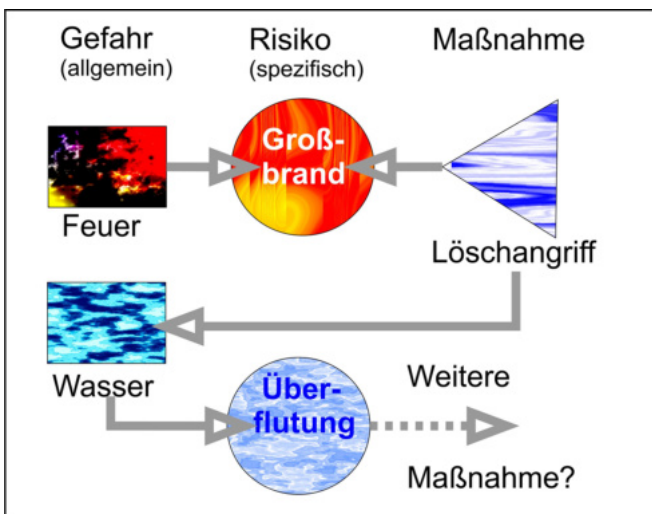
Abb. 2-9 Sekundärrisiko durch Einsatz von Löschmittel
